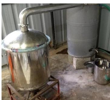
**b) Distillation apparatus**
